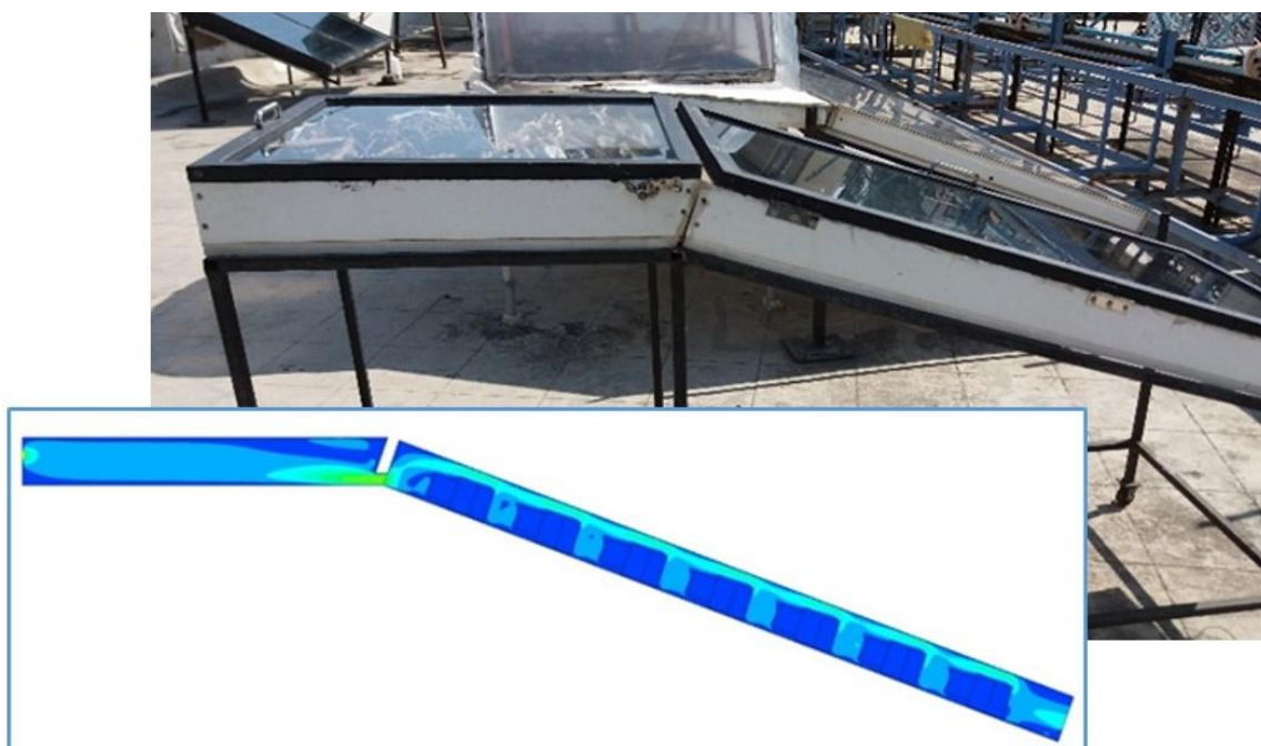
Фигура 3. Слънчева сушилна с акумулиране на латентна топлина в контейнери с парафин
