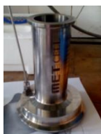
Фигура 2. Лабораторен модел на филтрационна клетка с плоска мембрана
